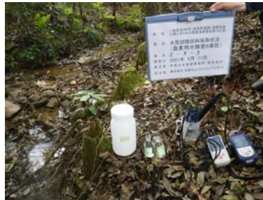
上流でトンネル工事が行われており、水質検査により河川の環境基準や農業用水の基準値との比較を行う
