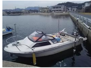
調査船に測定器を搭載し、流向・流速及び水深を測定
