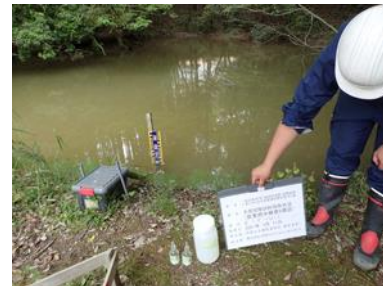
上流でトンネル工事が行われており、水質検査により河川の環境基準や農業用水の基準値との比較を行う
